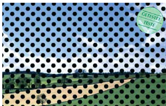
Trame pointillée avec un taux de couverture de 27 %, \varnothing 7,5 mm
