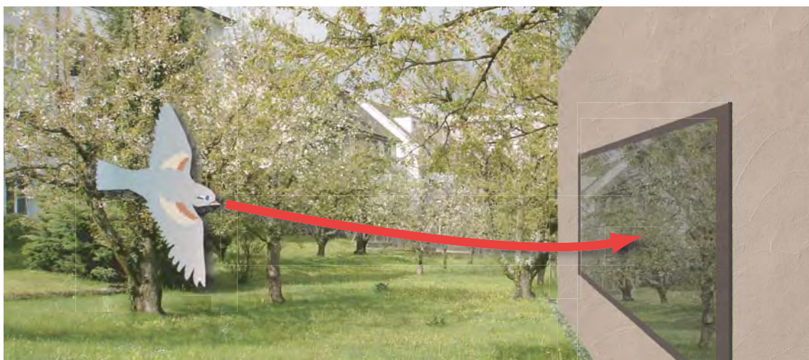
Les vitres protégeant du soleil et d'autres types de verres ont un degré de réflexion élevé. Plus l'environnement est réfléchi et plus il est naturel, plus il y aura de collisions.
