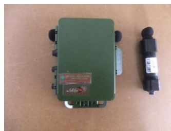
Installation d'un boîtier Song Meter SM4 (à gauche)- boîtier et micro Song Meter SM4 © William Guffroy (à droite)
