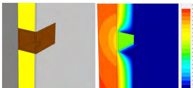
Déperdition thermique sans intégration d'isolant à l'arrière du nichoir © CSTB
